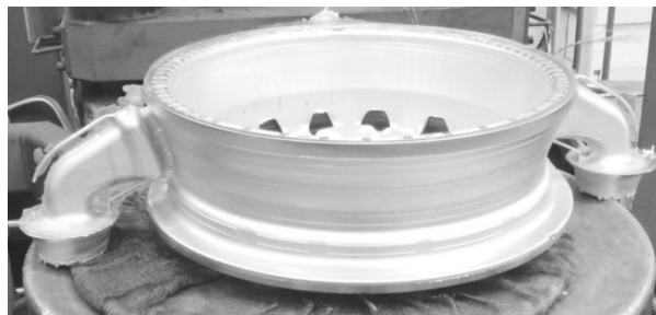
图11 双边浇毛坯的铸造飞边 (改善后)
